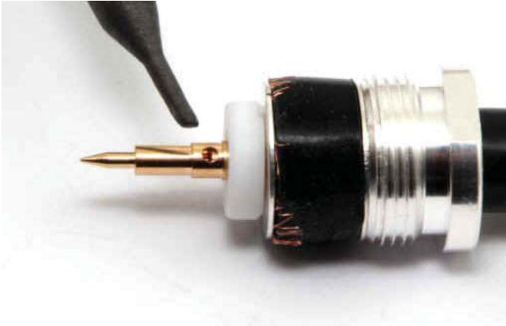
Die PTFE-Scheiben besitzen jeweils eine Aussparung, so dass sie einen geschlossenen Zylinder bilden, der die Rückhaltevorrchtung auf dem Mittelstift einschließt. Der Mittelstift hat somit *immer* dieselbe Position im Gehäuse. (Bilder 10 und 11)
