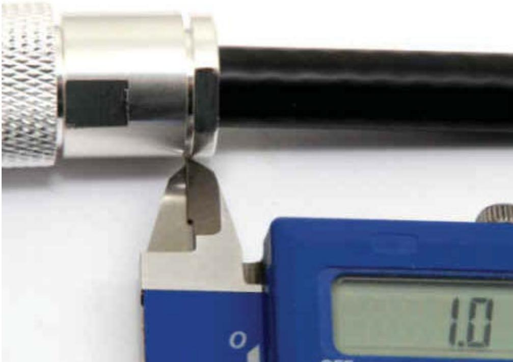
**Achten Sie bitte darauf, dass zwischen dem Gehäuse und der Spannschraube ein Spalt von ca. 1 mm bleibt.**
